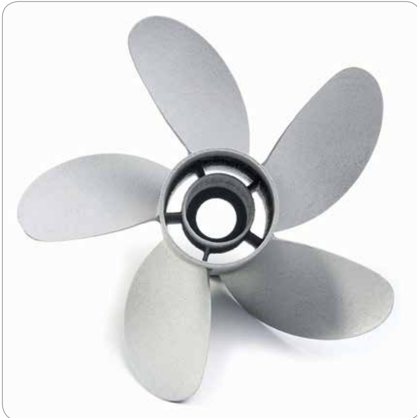
Antriebspropeller für Rennboote als verkleinertes Modell zur Strömungsmessung
